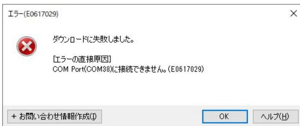
通常エラーが出ます。理由はプログラムが作られた環境とお客様の PC 環境で COM 番号が違うからです。そこで、RL78 COM Port (デバック・ツール) をクリック→デバックの構成から COM ポート番号を合わせます。通信ポートをお客様の PC で設定された COM ポートに合わせます。例では COM38 から COM37 に変更。
